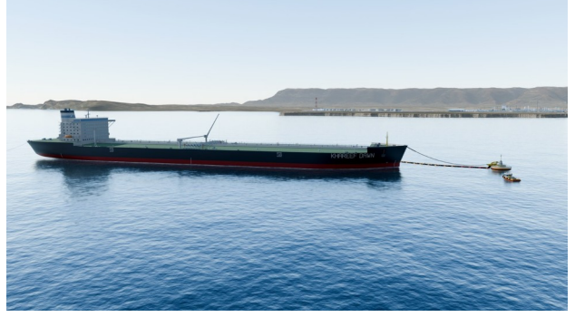
الشكل 7. استيراد النفط الخام: ناقلة نفط عملاقة (VLCC) راسية عند عوامة الإرساء الأحادية الشكل 8. تصدير المنتجات: ناقلة منتجات متوسطة الحجم (MR) عند رصيف سوانل في ميناء صلالة
